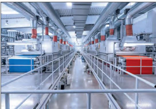
Trockner einer Beschichtungsanlage zur Herstellung des *Premium Car Wrapping Films*
