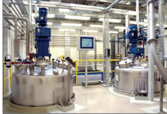
Misch- und Ansatz tanks zur vollautomatischen Herstellung von Basisorganosolen (= Lack)
